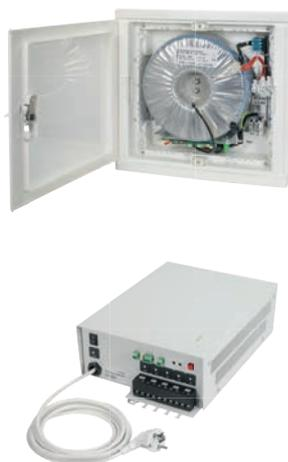
Der Einbau ist dank des **E-ENERGY CARBON** Trafos mit Sicherheitskleinspannung (SELV) komplett sicher. Die interne Sicherheitstemperaturüberwachung gehört ebenso zum Funktionsumfang wie der Anschluss eines Bodenfühlers und ein Funkchip zum Anschließen eines Funkreglers. Als Auf- und Unterputzvariante erhältlich.
