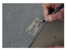
Bei zugeschnittenen Folien gemessene Widerstände auf beiliegenden Etiketten eintragen und auf der Heizfolie aufkleben.
